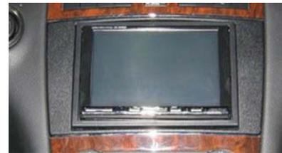
\* Установочные комплекты Alpine KTE предназначены для инсталляции мультимедийной станции Alpine IVA-W200Ri (2 DIN).
